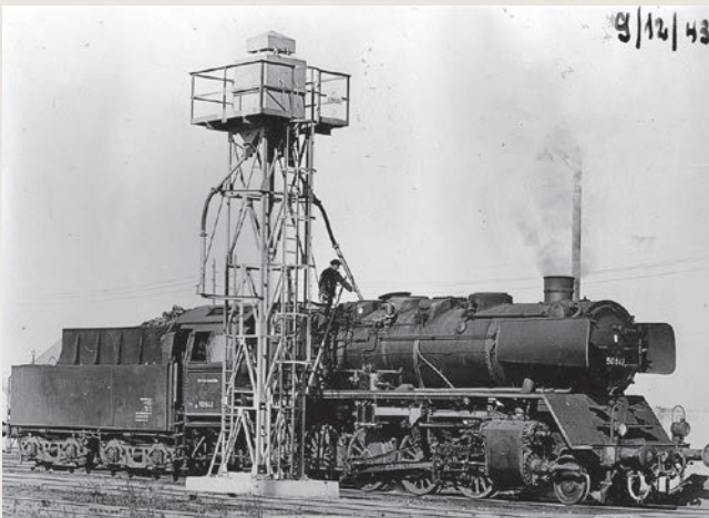
Neben Kohle und Wasser benötigten Dampflokomotiven auch Sand zum Anfahren schwerer Züge und zum Bremsen. Hier wird eine Lok mit Hilfe eines Besandungsturmes bestückt.
